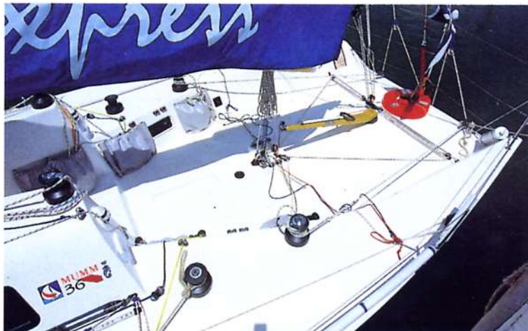
Sopra, a sinistra, le cuccette della zona del quadrato del Mumm 36. Sopra, il pozzetto con tutte le manovre rinviate al centro. Il trasto della randa è a poppa della barra del timone, quattro i winch.
