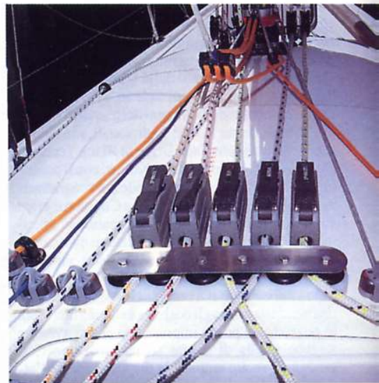
Sopra, la batteria di stopper sulla tuga. A destra, la zona carteggio. A lato, un Mumm 36 sotto spinnaker.
